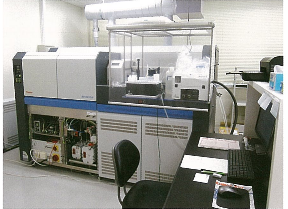
本館所有のマルチコレクタICP質量分析装置 鉛やストロンチウムの同位体比測定から、青銅や人骨などの分析を行うことができる。
